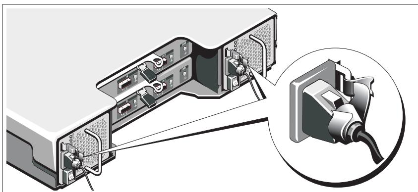
Sistemin güç kablolarını resimde gösterildiği gibi eğin ve kabloları sistemle birlikte verilen kayışı kullanarak desteği sıkıca sabitleyin.
