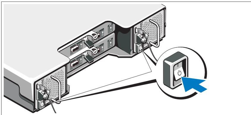
Ponga el commutador de alimentación en la posición de encendido. Los indicadores de alimentación deberían encenderse.
