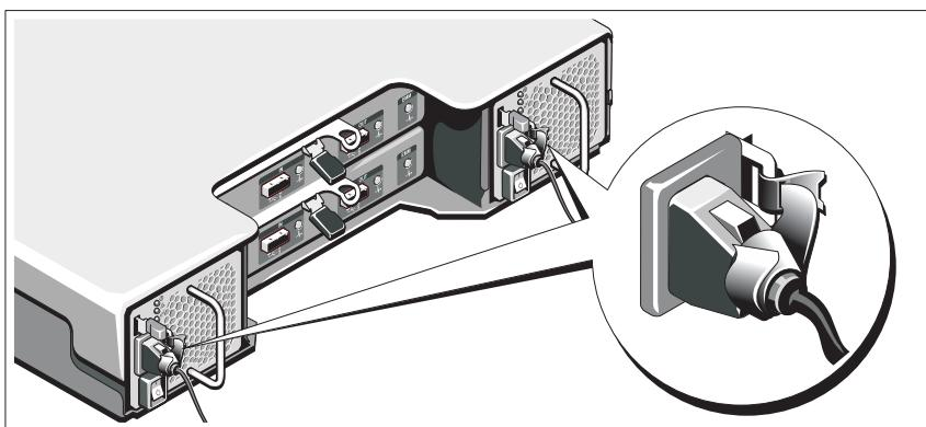
Doble los cables de alimentación del sistema en forma de bucle, como se muestra en la ilustración, y fíjelos al soporte con la correa proporcionada. Conecte el otro extremo de los cables de alimentación a una toma eléctrica con conexión a tierra o a otra fuente de energía, como por ejemplo un sistema de alimentación ininterrumpida (SAI) o una unidad de distribución de alimentación (PDU).
