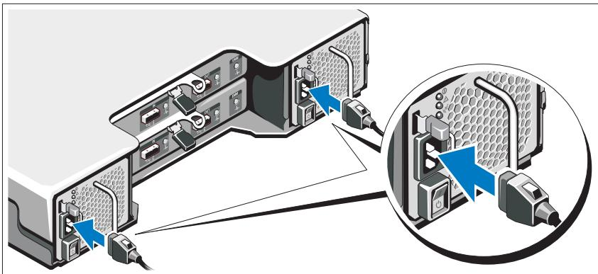
Βεβαιωθείτε ότι ο διακόπτης τροφοδοσίας είναι στη θέση OFF πριν συνδέσετε το καλώδιο(α) τροφοδοσίας ρεύματος. Συνδέστε τα καλώδια τροφοδοσίας στο σύστημα.
