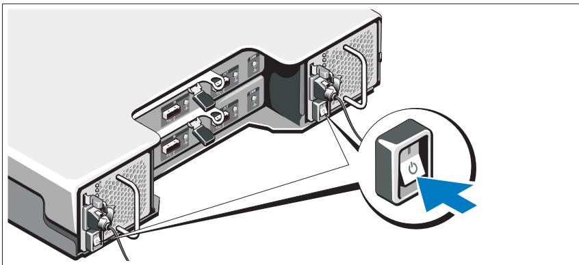
Přepněte vypínač do polohy ZAPNUTO. Indikátory napájení by se měly rozsvítit.
