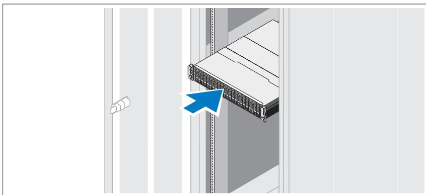
Συναρμολογήστε τις ράγες και εγκαταστήστε το σύστημα σε rack σύμφωνα με τις οδηγίες ασφάλειας και τις οδηγίες εγκατάστασης σε rack που παρέχονται με το σύστημά σας.
