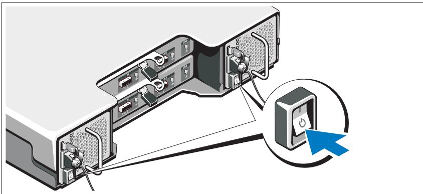
Stellen sie den Netzschalter auf die Position ON (EIN). Daraufhin sollten die Betriebsanzeigen aufleuchten.
