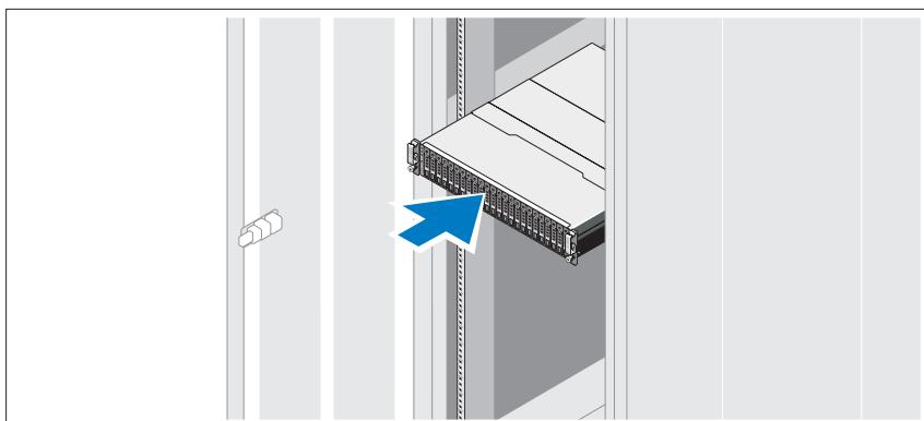
Monte los rieles e instale el sistema en el estante siguiendo las instrucciones de seguridad y de instalación del estante incluidas con el sistema.
