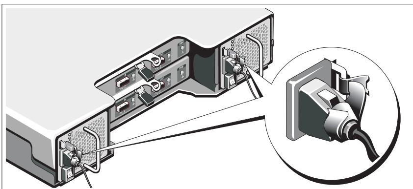
Κάμψτε το καλώδιο(α) τροφοδοσίας του συστήματος όπως φαίνεται στο σχήμα και στερεώστε το/τα στο στήριγμα χρησιμοποιώντας τον ιμάντα που παρέχεται.
