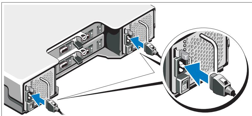
Stellen Sie sicher, dass der Netzschalter auf der OFF (AUS)-Einstellung ist, bevor Sie das bzw. die Stromkabel verbinden. Verbinden Sie das bzw. die Netzstromkabel mit dem System.
