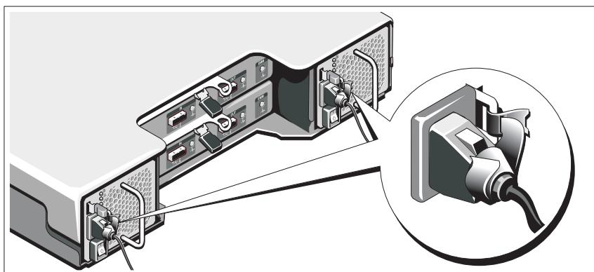
Bilden Sie mit dem bzw. den System-Netzstromkabel(n) wie abgebildet eine Schlaufe, und sichern Sie das bzw. die Kabel mit dem beigefügten Riemen an der Klammer.
