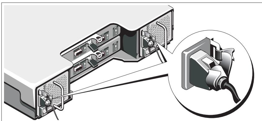
Zegnij kabel (kable) zasilania komputera w pętlę, w sposób przedstawiony na rysunku i zamocuj kabel (kable) na wsporniku, używając załączonej opaski.
